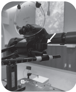
図2. 白矢印部のネジがゆるむ(左図)、ゆるみの有無で目盛りの振り幅が変わる(右図)
